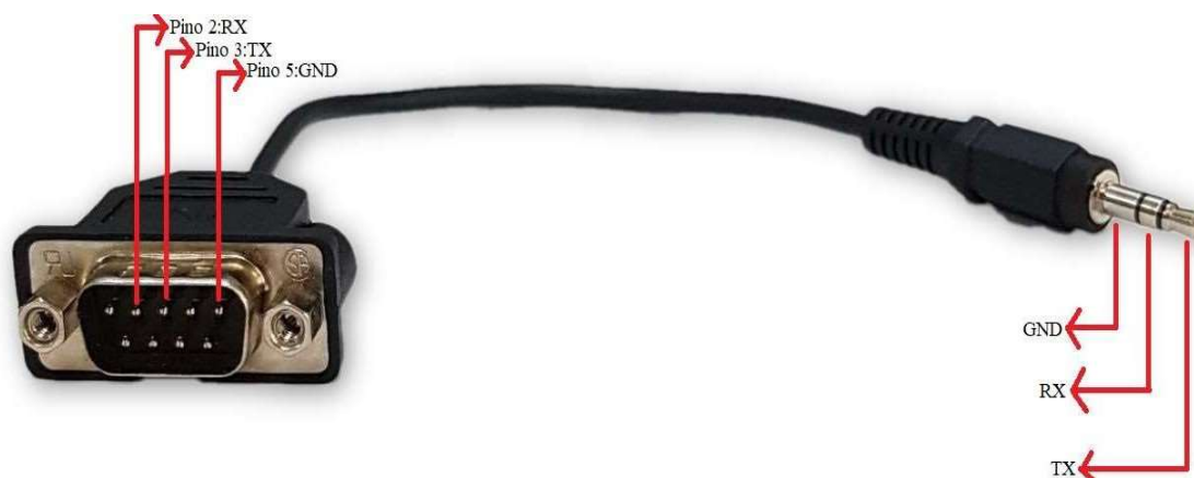
Figura 2 – Cabo “P2-DB9 Macho”
